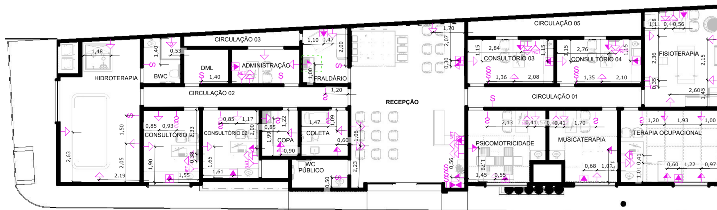
02 PLANTA DE PONTOS ELÉTRICOS ESCALA: 1 : 125
